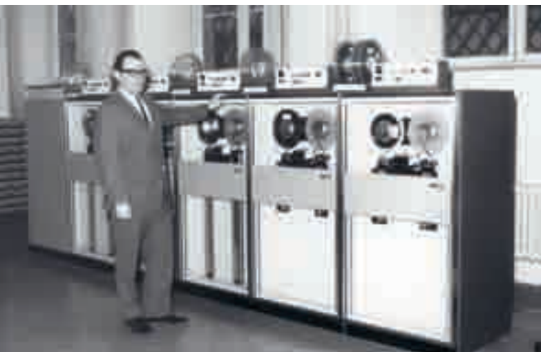
Mitte links: Maschinensaal des Bayerischen Statistischen Landesamts 1970. Die damals neue EDV-Anlage IBM 360/30 hatte eine Speicherkapazität von 64 Kilobyte.
